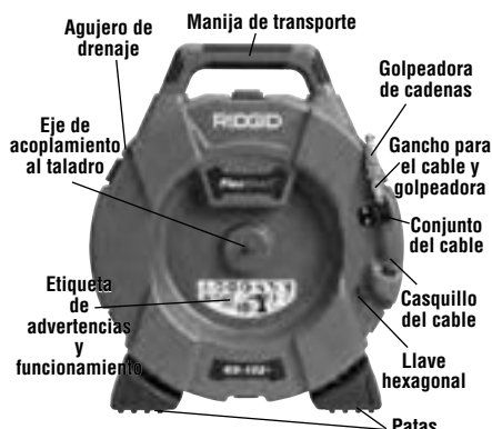
Figura 1A – Limpiadora de desagües FlexShaft de RIDGID®
