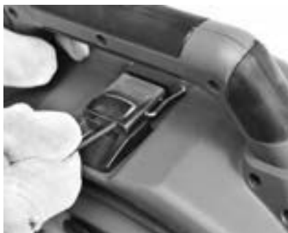
Abbildung 14 – Verschluss unter dem Tragegriff öffnen (mit Sechskantschlüssel)
