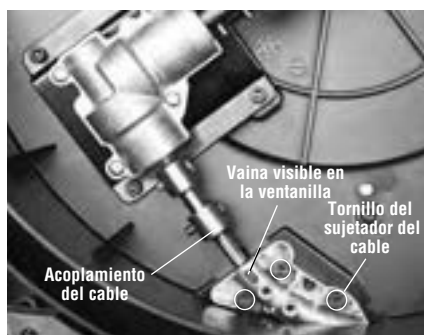
Figura 16 – Reemplazo del conjunto del cable
