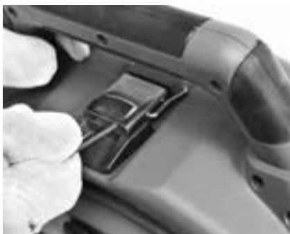
그림 14 – 운반 핸들 아래에 있는 래치를 엽니다 (육각 렌치 사용)
