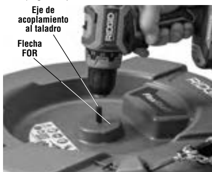
Figura 4 – Conexión del taladro al eje de acoplamiento
